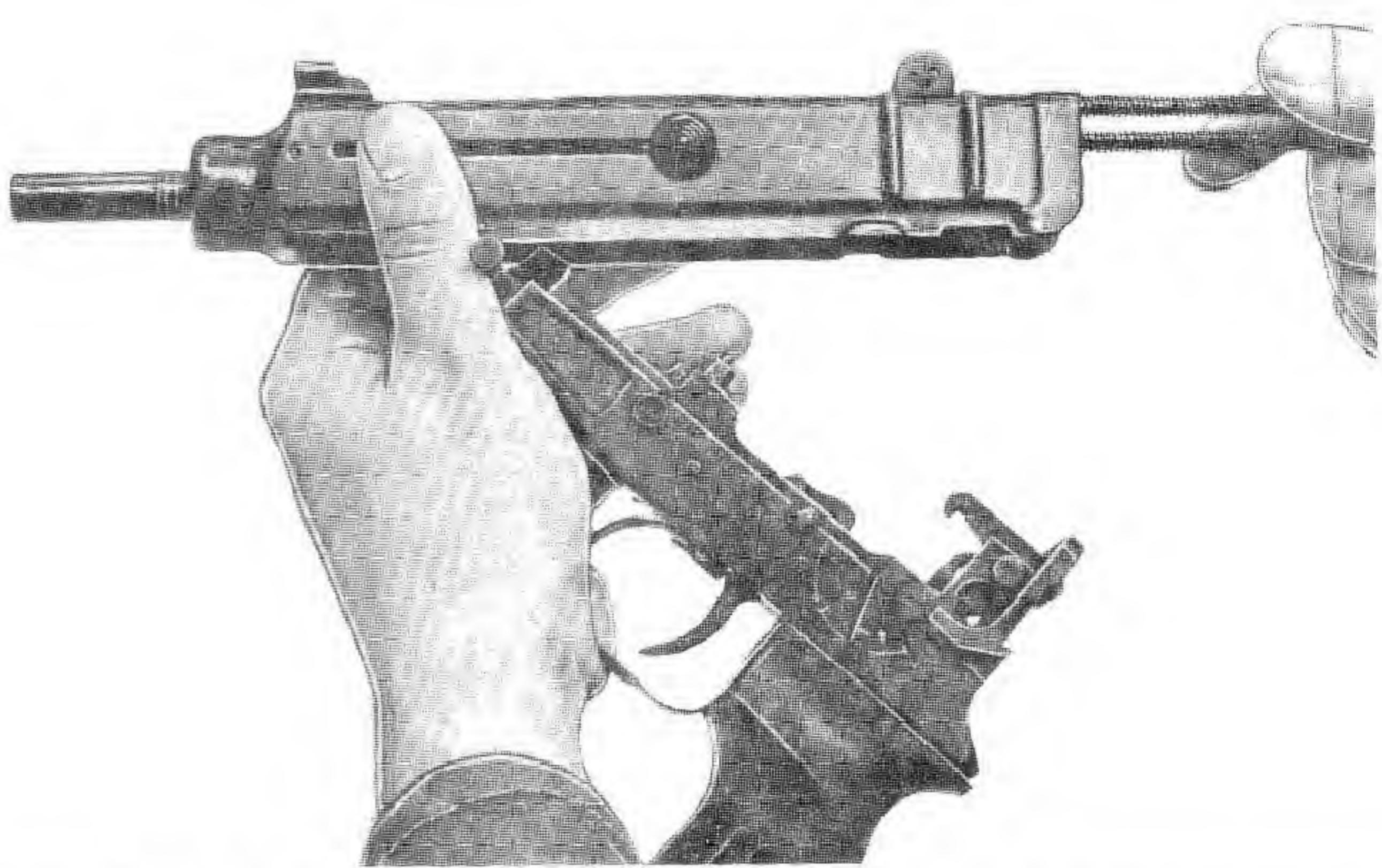
Sl. 52 – Dovođenje zatvarača u položaj za odvajanje hvatača za povlačenje zatvarača
